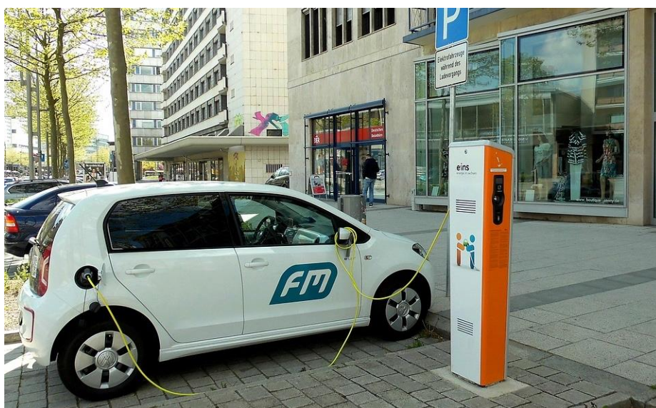
Ilustrācija 31. Elektroauto ielas uzlāde Vācijā izmantojot taisno uzlādes vadu.
